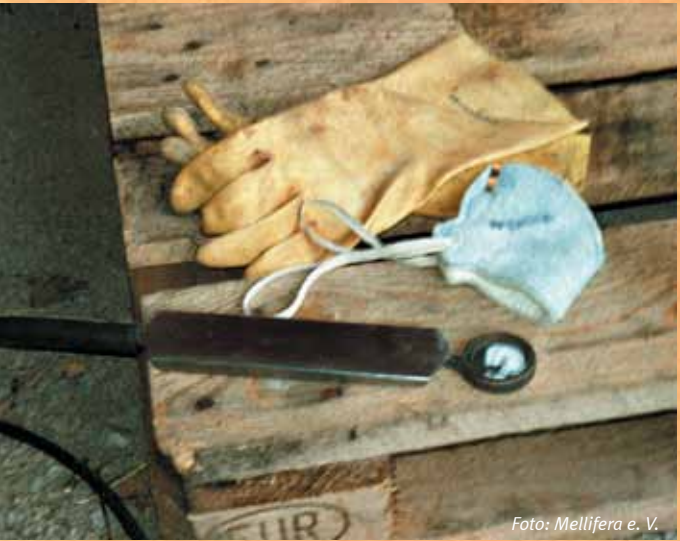
Prototyp des „VARROX“ mit Schutzkleidung. Das Pfännchen wird durch das Flugloch in der Beute platziert. Über eine Autobatterie wird das Pfännchen erhitzt, die Oxalsäure verdampft und verteilt sich gleichmäßig im Bienenvolk.
