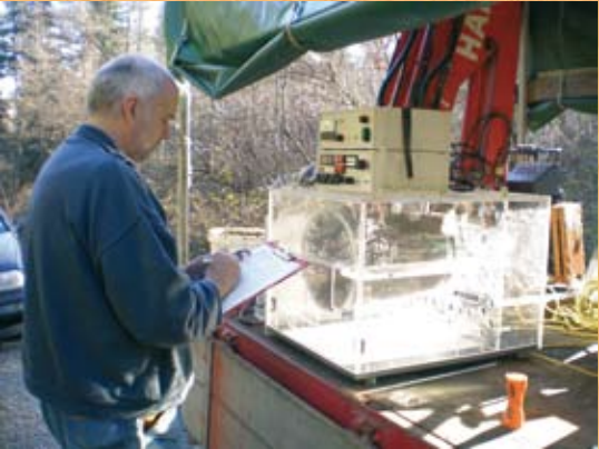
Norbert Poeplau dokumentiert die Versuche zur Bekämpfung der Varroamilbe mit Wärme.
